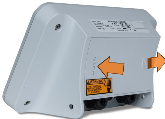
Abbildung 2-19: Entfernung des Batteriedeckels
