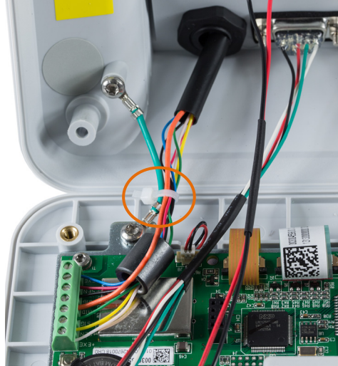
Figura 2-24: Instalação de Ferrite e Pino Terra da Célula de Carga Analógica, IND231
