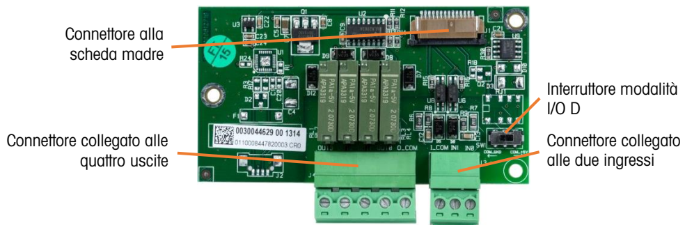
Figura 2-40: Scheda opzionale I/O discreto
