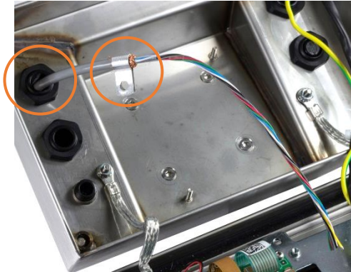
Figura 2-31: Passaggio del cavo della cella di carico nella scocca del terminale IND236, con il fermaglio di terra.
