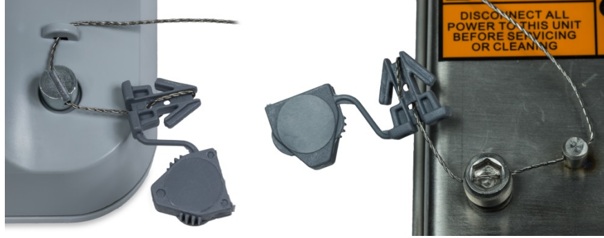
Figura 2-46: Instalación del sello, IND231 (izquierda) e IND236 (derecha)
