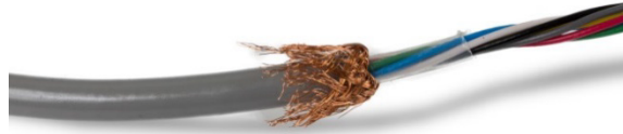
Figura 2-26: Cavo della cella di carico dopo aver ripiegato il filo di schermatura
